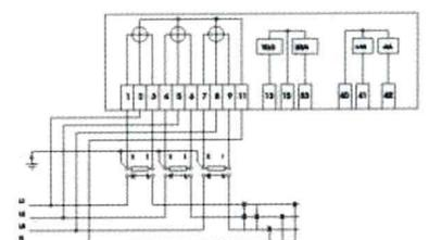
b. Diagrama de conexión a través de TC
